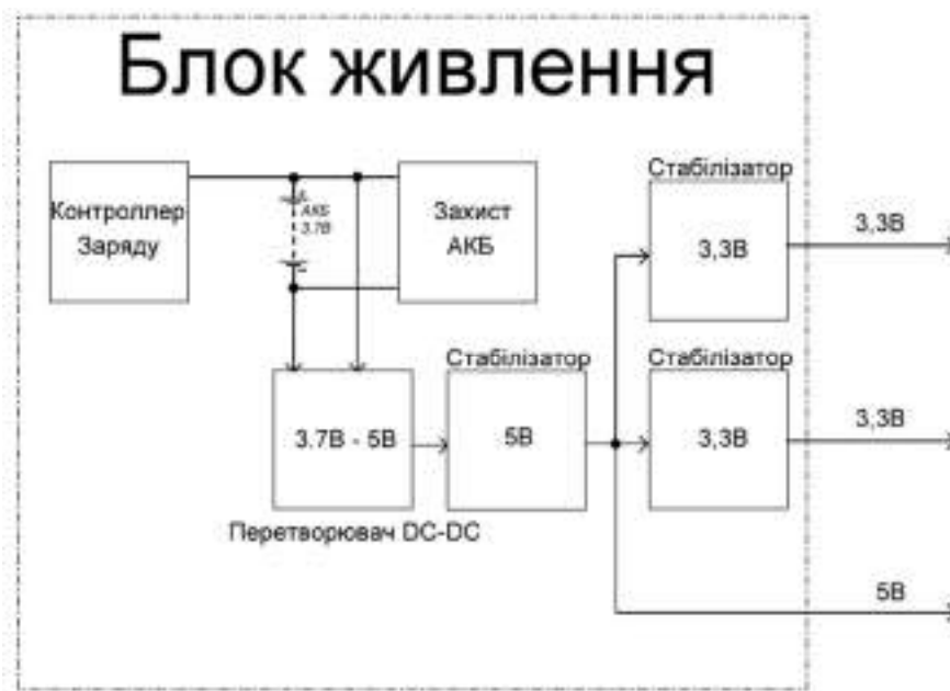
Рисунок 3.2 — Схема електрична структурна. Живлення схеми. Результатом підрозділу є розробка схеми структурної електричної.
