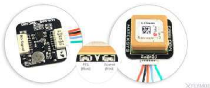
Рисунок 3.39 — GPS -модуль з компасом [9]
