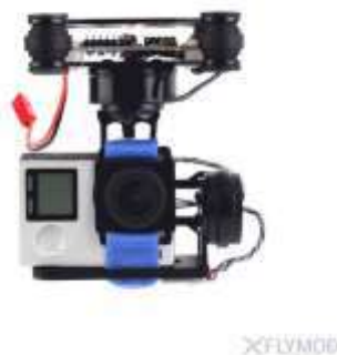
Рисунок 3.38 — Гіростабілізована платформа з встановленою камерою [8]
