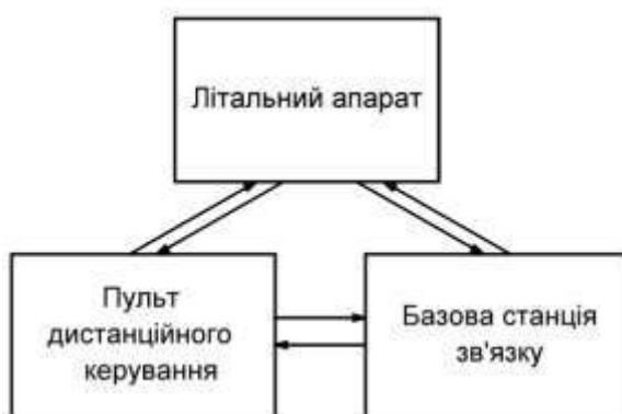
Рисунок 3.7 — Структурна схема БАК
