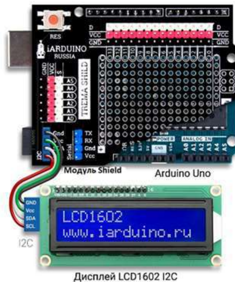
Рисунок 5.2 — Схема підключення дисплею до плати Shield
