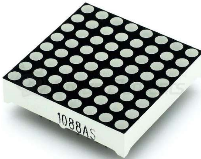
Рисунок 3.4 — Led матриця 8 на 8 модель 1088AS.
