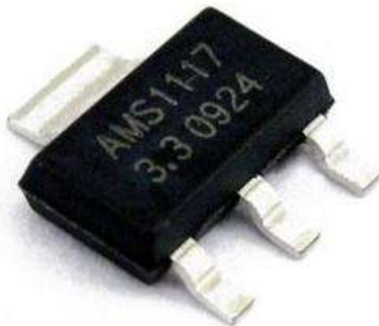
Рисунок 3.8 — Стабілізатор ams-1117 в SMD корпусі.
