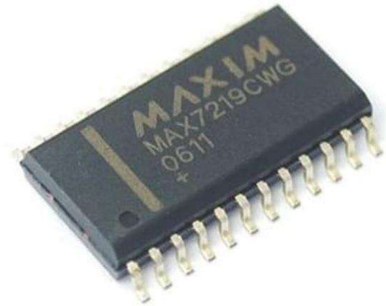
Рисунок 3.5 — Мікросхема MAX7219 в SMD корпусі.
