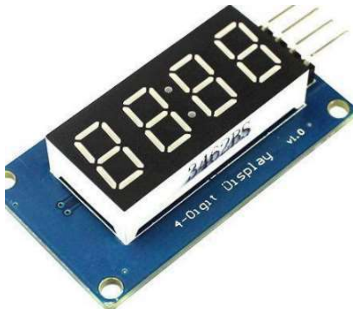
Рисунок 2.11 - Модуль 7-ми сегментного індикатора ТМ-1637
