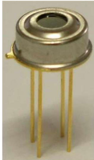
Рисунок 2.8 – Інфрачервоний датчик температури MLX90614
