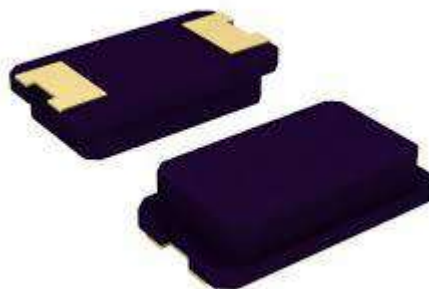
Рисунок 3.15 — Кварцевий резонатор АВМ7
