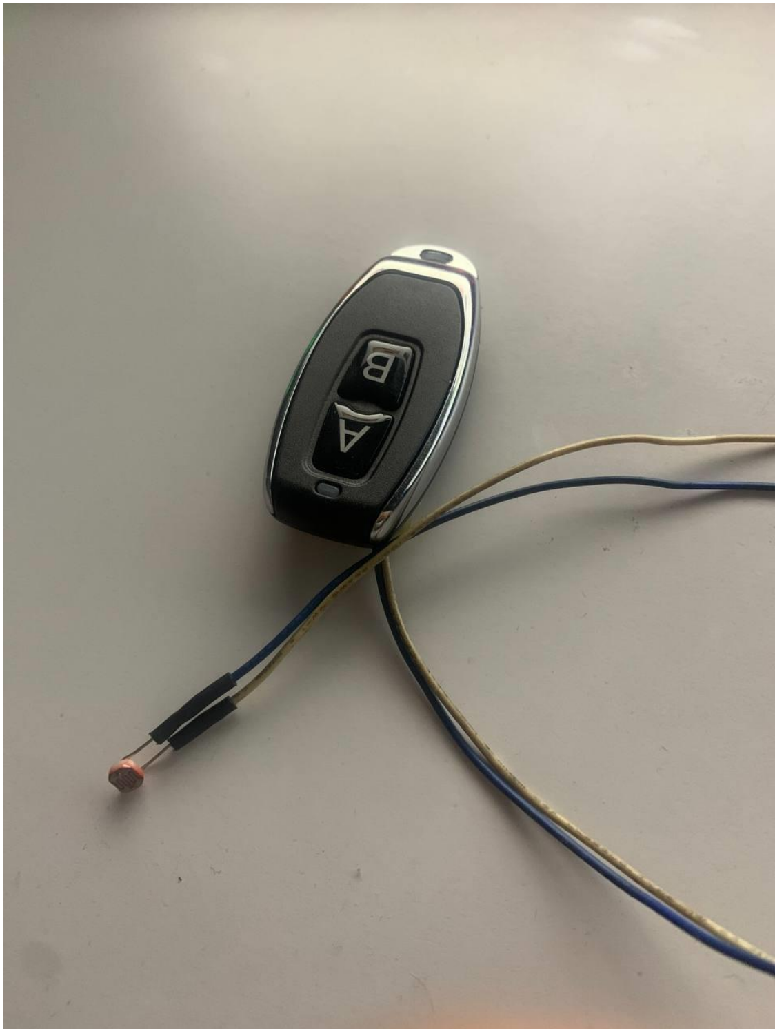
Рисунок 3.6 – Вигляд пульта дистанційного керування з фоторезистором
