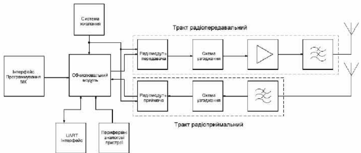
Рисунок 2.2 — Схема електрична структурна ЕМ у складі БСЗ
