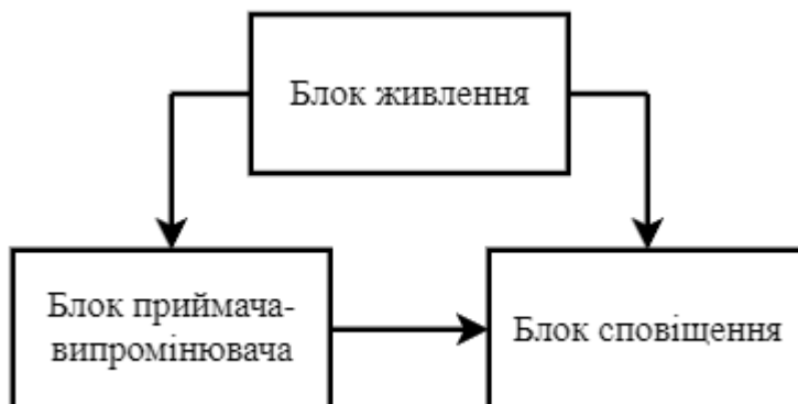
Рисунок 3.1 — Структурна схема сенсора
