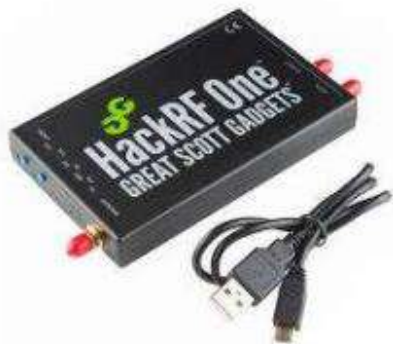
Рисунок 1.8 – Генератор завад на основі SDR HackRF.
