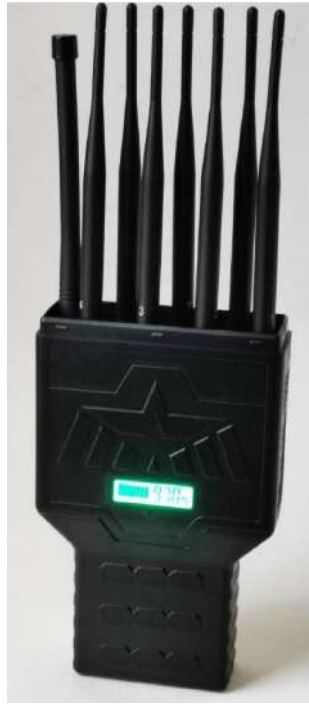
Рисунок 1.7 — Генератор завад “Titan Pro”.
