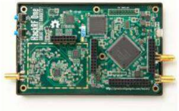
Рисунок 1.8 – Генератор завад на основі SDR HackRF.
