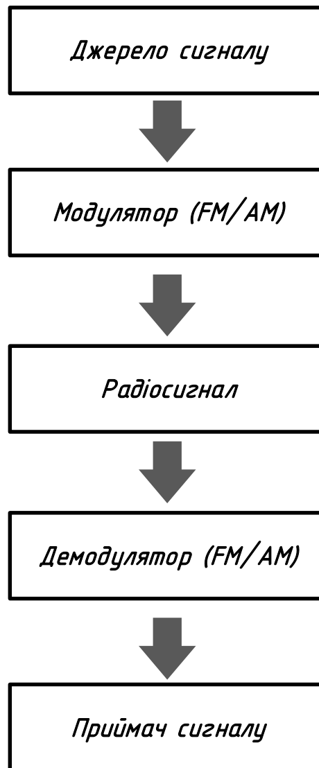
Рисунок 1.2 — Загальна схема бездротового передавання аналогового сигналу.
