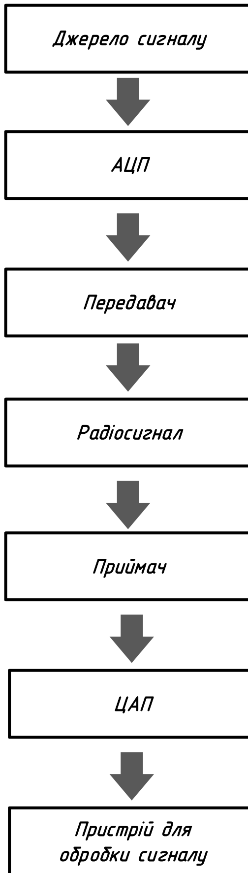
Рисунок 1.3 — Загальна схема передавання сигналу цифровим способом
