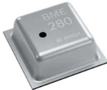
Рис. 2.8 – BME у корпусі 2,5 \times 2,5 (мм 2 )
