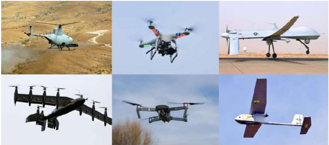
Рис. 1.3 – Приклади різноманітних конструкцій дронів: однороторні, багатороторні, з нерухомим крилом, гібридні з нерухомим крилом
