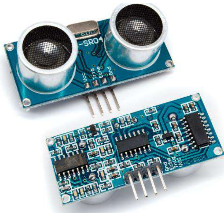
Рисунок 3.10— Модуль далекоміру HC-SR04
