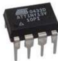
Рисунок 3.1 — Мікроконтролер Attiny13a, фірми Atmel
