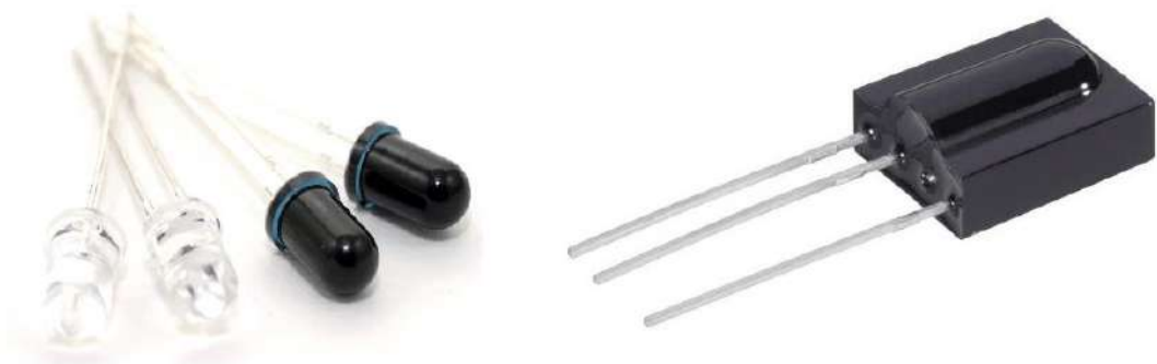
Рисунок 2.7 – ІЧ-світлодіоди, ІЧ-фотодіоди та TSOP1738
