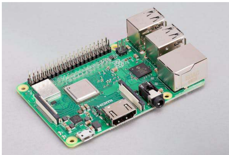
Рисунок 3.3.1.1 Мікрокомп'ютер Raspberry Pi 3 model B+
