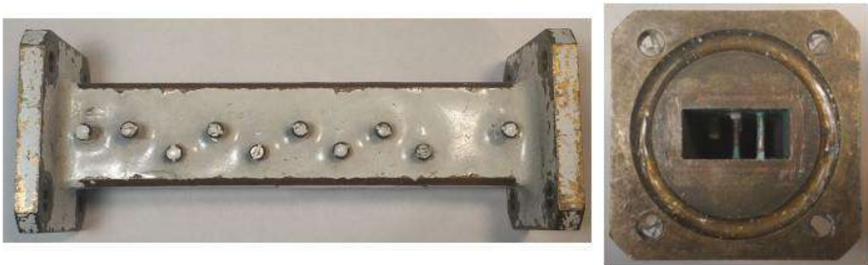
Рис. 2.6 Хвилевідний фільтр з металевими стержнями
