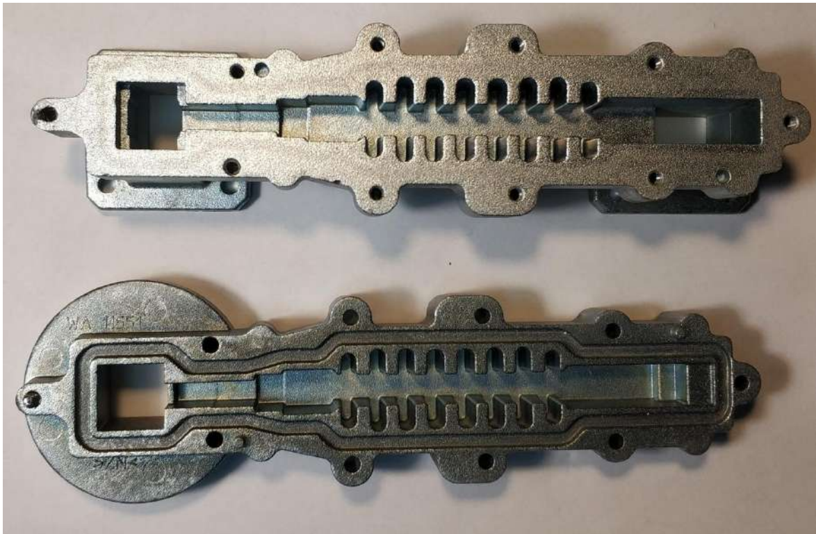
Рис. 2.16 Хвилевідний фільтр у складі пристрою виготовлений методом лиття
