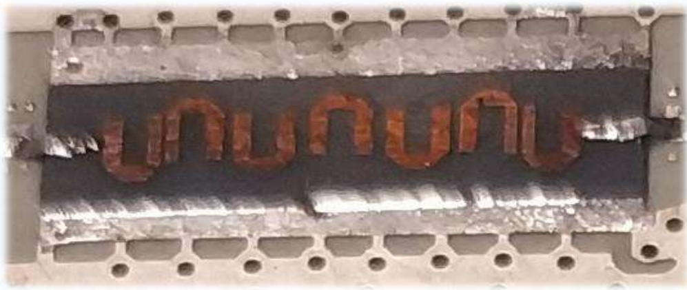
Рис. 2.2 Мікросмушковий фільтр на підложці з високою діелектричною проникністю
