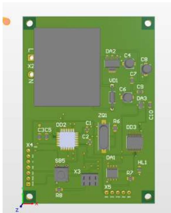
Рисунок 5.2 – Електронний модуль блоку керування кавомашини : вид зверху
