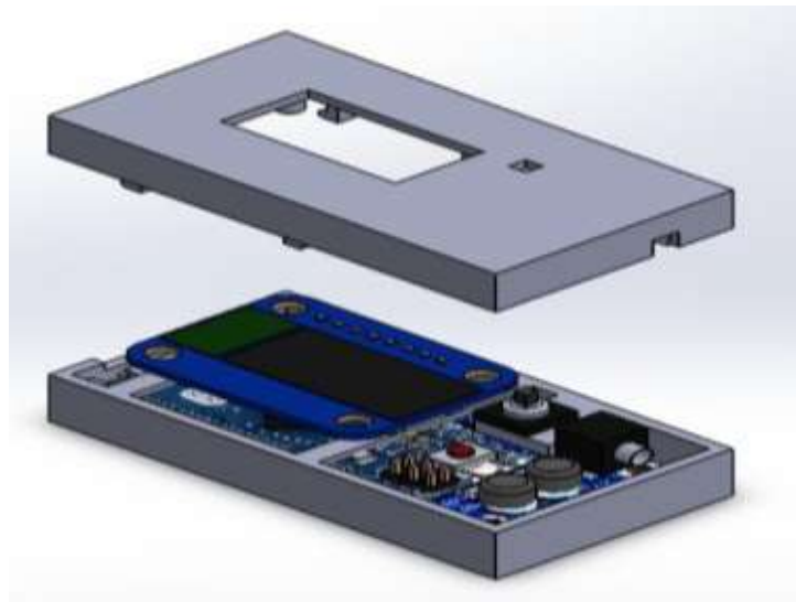
Рисунок 5.4 – Зовнішній та внутрішній вигляд 3D конструкції цифрового програвача аудіо контенту
