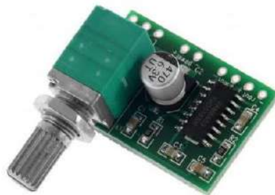
Рисунок 2.8 — Аудіопідсилювач на РАМ8403 з регулятором гучності [12]
