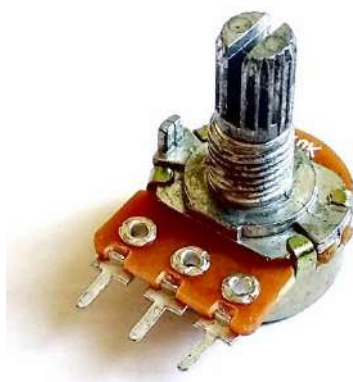
Рисунок 2.14 — Змінний резистор (потенціометр) В100К [17]
