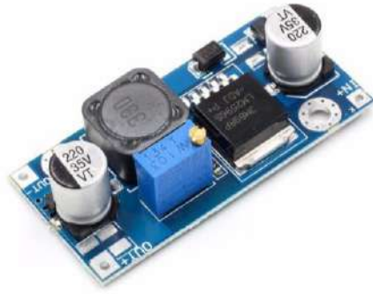
Рисунок 2.7 — Понижуючий DC-DC перетворювач напруги LM2596 [11]
