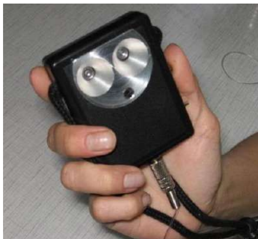
Рисунок 1.2 — Ультразвуковий «ліхтар» для сліпих Сонар-5УФ-В4 [2]
