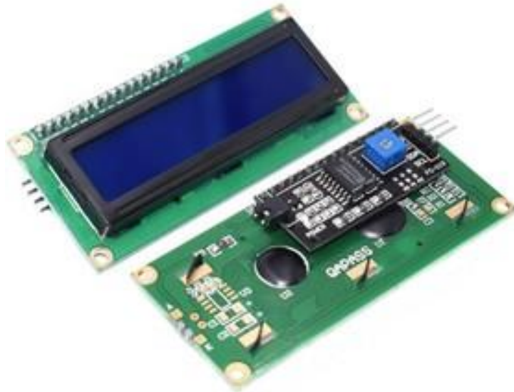
Рисунок 3.3 – Модуль SPI/I2C 1602 LCD [2]
