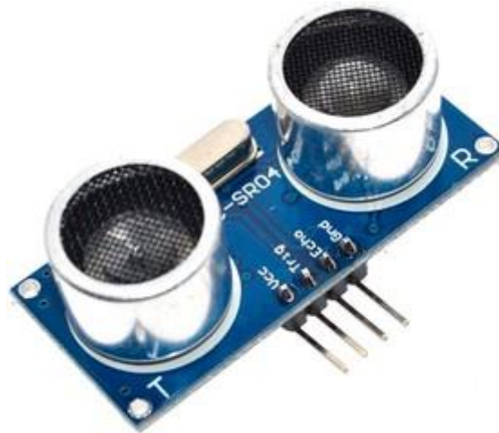
Рисунок – 3.7 Модуль Ультразвуковий далекомір HC-SR04 [6]
