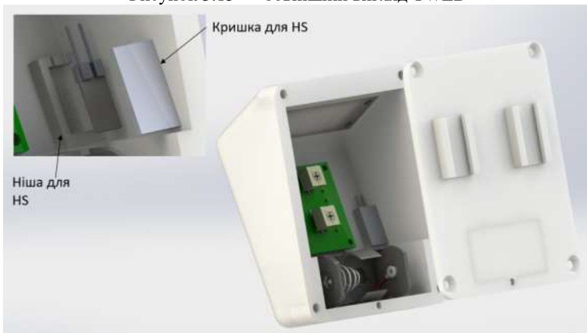
Рисунок 3.16 — Зовнішній вигляд TWLD з тильної сторони
