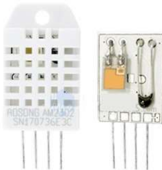
Рисунок 2.8 — Внутрішня будова DHT22 [22]
