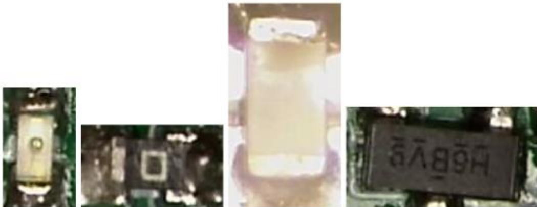
Рисунок 4.1 — Зображення діода, резистора, конденсатора та транзистора SMD
