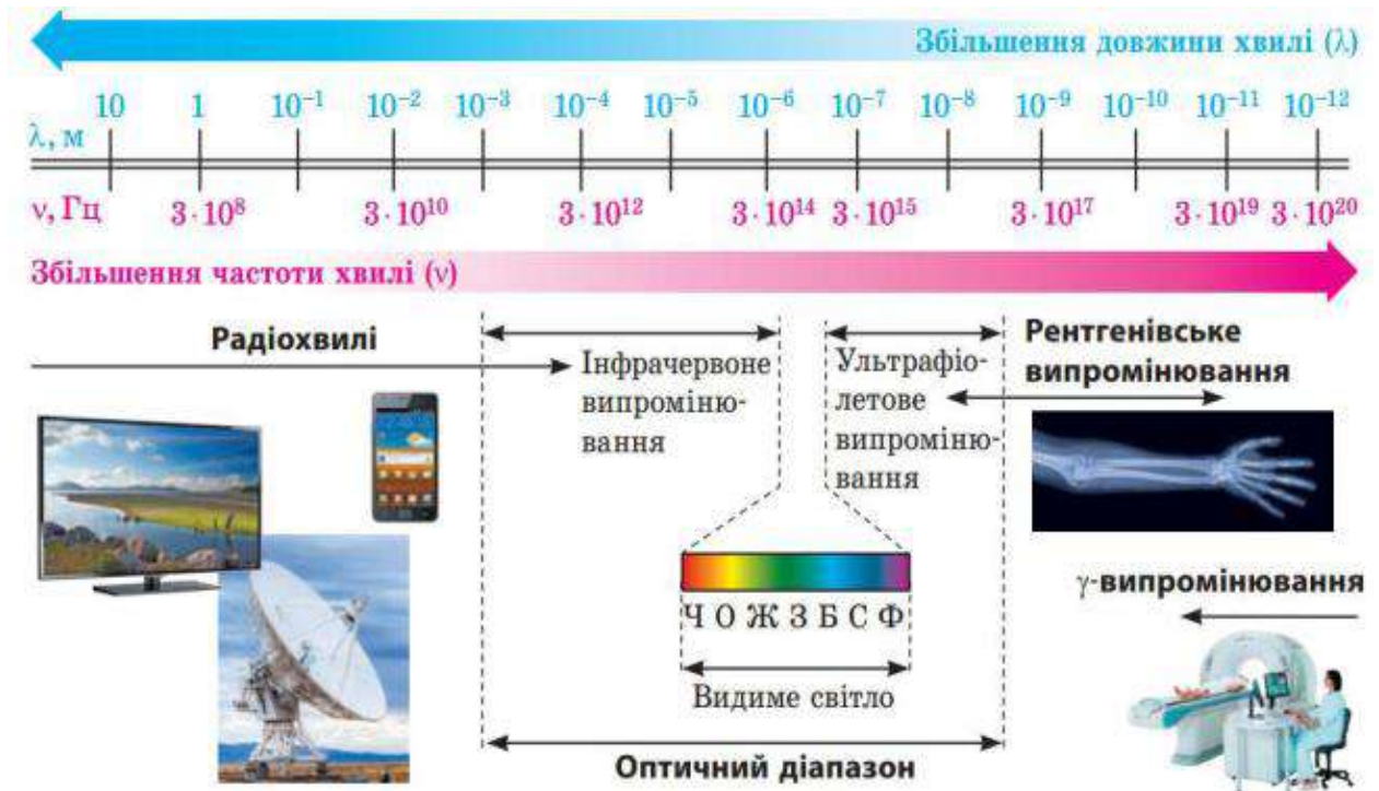
Рисунок 1.3 — Частотний діапазон хвиль випромінювання
