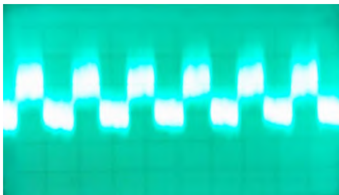
Рис. 2.3 Виділений сигнал на виході смугового фільтра підсилювача [17].
