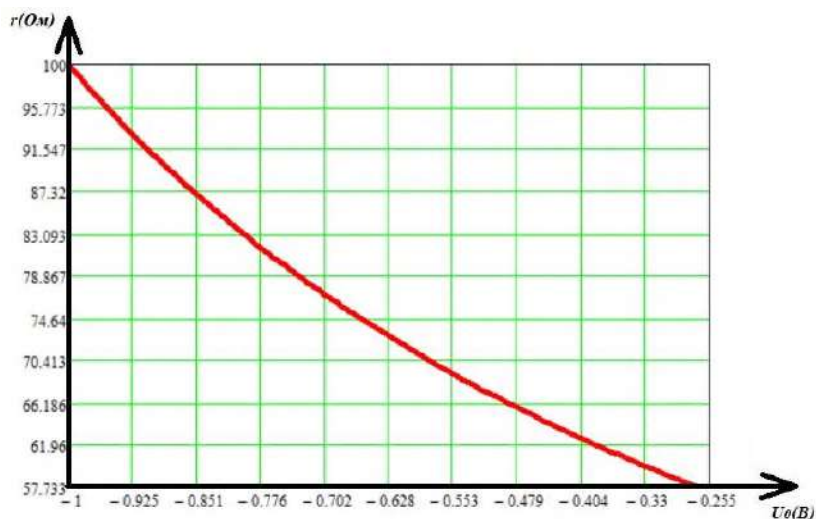
Рис.2.14 Залежність опору польового транзистора JFET з каналом n-типу ввімкненого як VCR від керуючої напруги на робочій ділянці.
