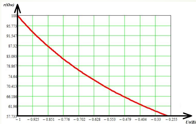
Рис.9 Залежність опору польового транзистора JFET з каналом n-типу ввімкненого як VCR від керуючої напруги на робочій ділянці.
