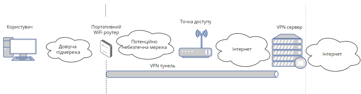
Рисунок 4.1.1 – Топологія мережі при типовому використанні портативного роутера
