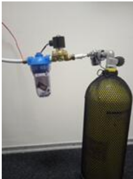
Рисунок 3.1—кисневий балони з під'єднанням до нього редуктором.
