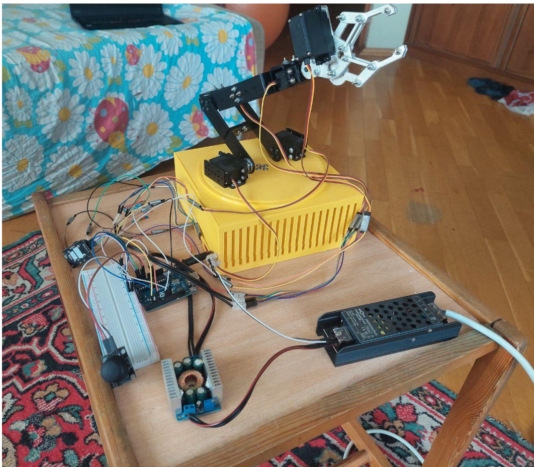
Рисунок 2.5 — Зібраний маніпулятор з керуванням від джойстиків
