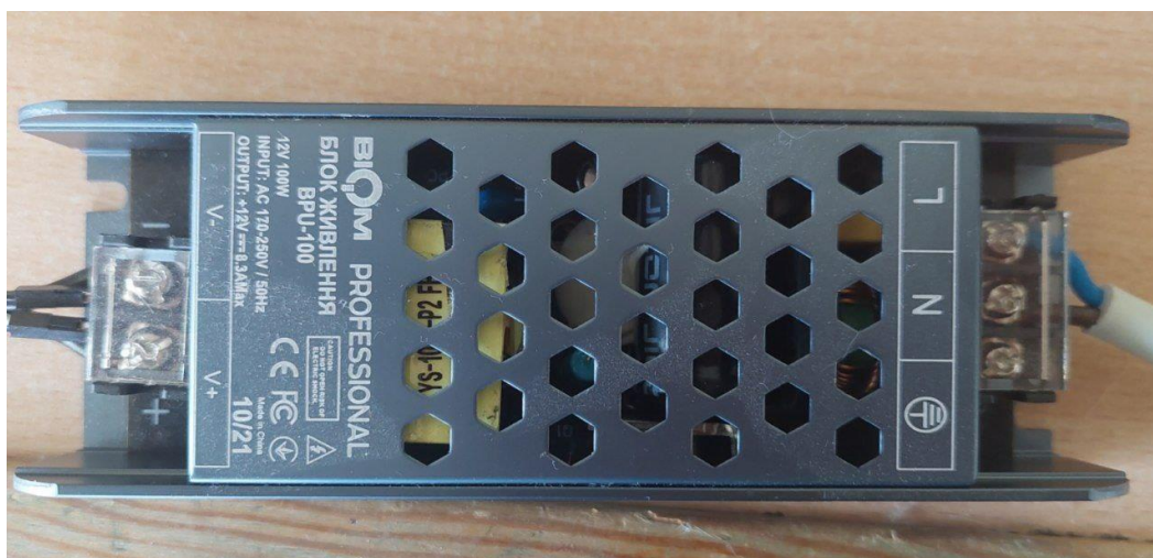
Рисунок 2.1 — Блок живлення понижуючий з 220 вольт на 12 вольт
