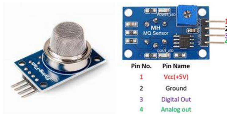
Рисунок 2.5 — Датчик MQ-2 та його розпіновка[11]
