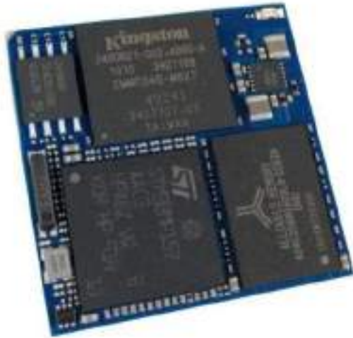
Рисунок 1.1 — Контролер QSMP-1570 від Ka-Ro electronics [3]
