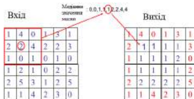
Рисунок 1.6 — Принцип роботи медіанного фільтра
