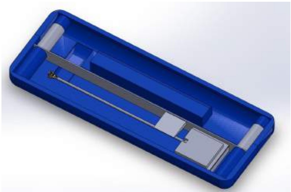
Рисунок 5.6 – Корпус – вигляд виводу для провода
