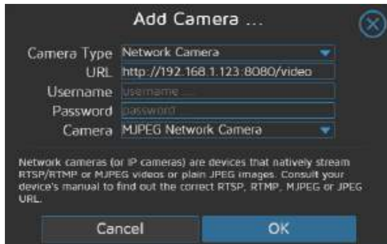
Рис. 3.4.2 - Приклад підключення безпроводної IP камери
