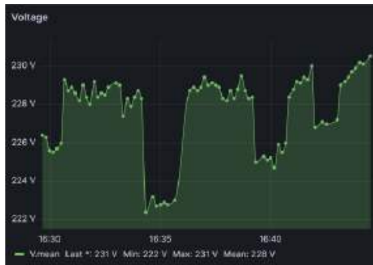
Рисунок 3.19 — Напруга увімкнених приладів
