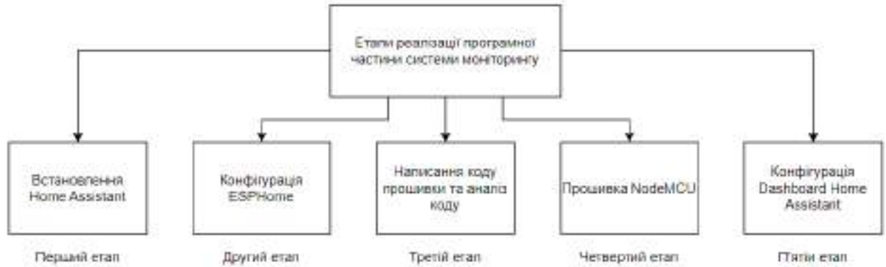
Рисунок 3.4 — Етапи реалізації програмної частини системи моніторингу
