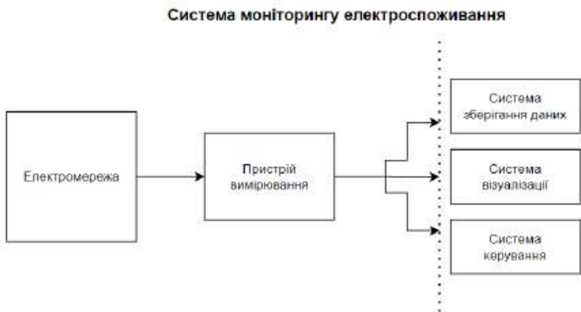
Рисунок 2.1 — Структурно-логічна схема системи моніторингу
