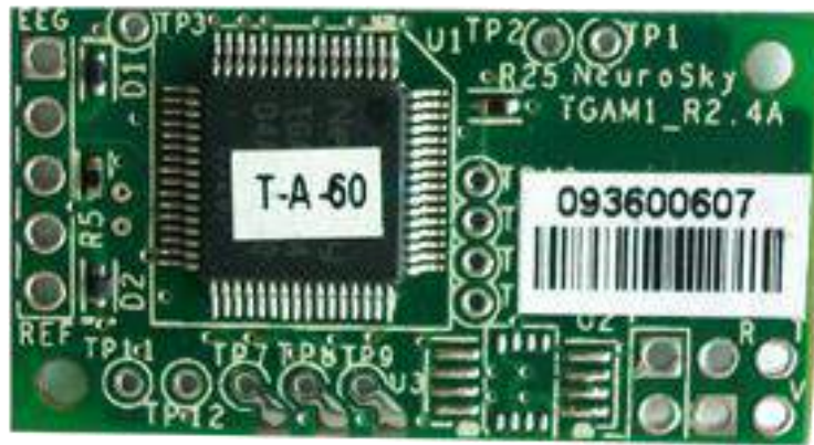
Рисунок 2.8 - Апаратний модуль ThinkGear ASIC від компанії NeuroSky.
