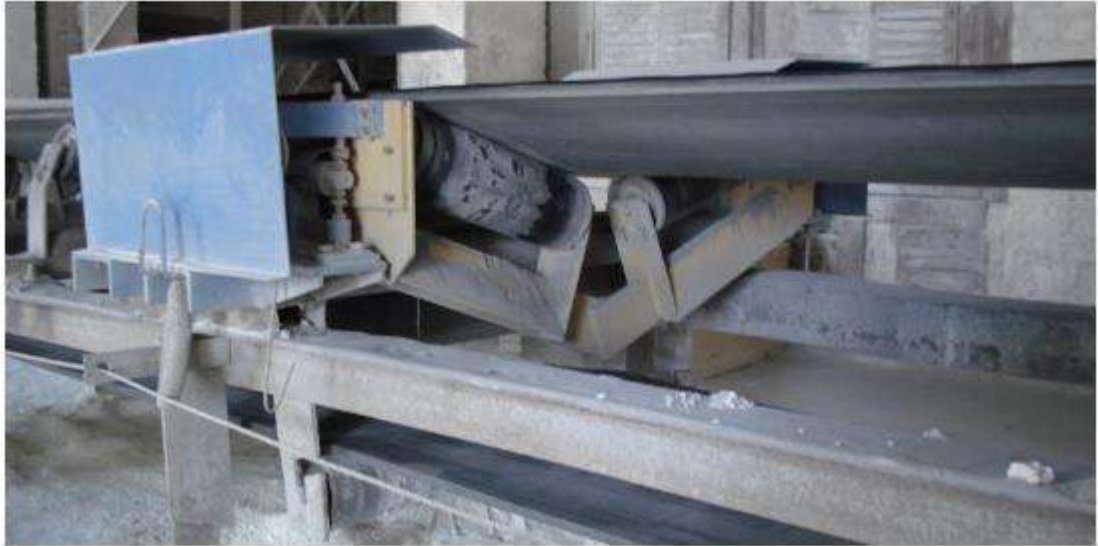
Рисунок 2.10 — Конвеєр Н-1000 та ваги ВКТ-4А
