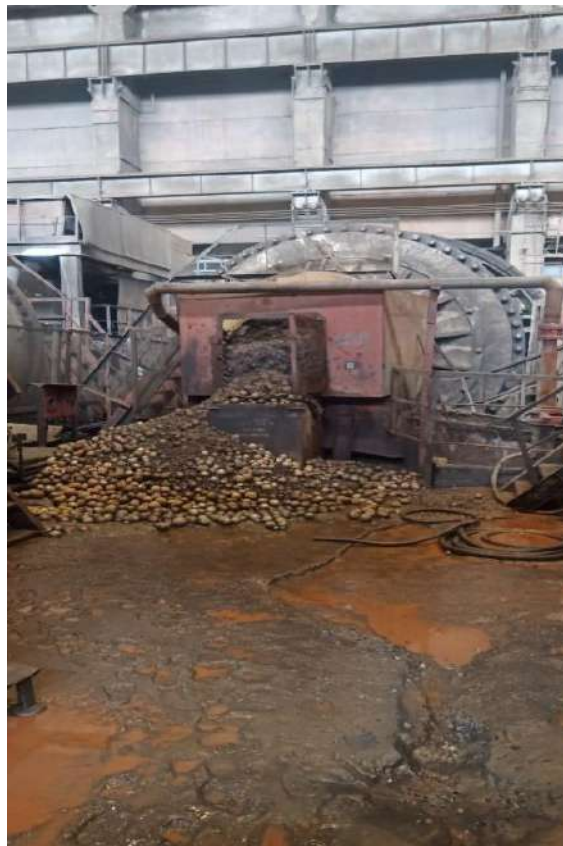
Рисунок 1.9 – Результат перевантаження млина МШЦ
