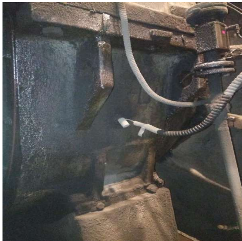
Рисунок 2.13 – Фото змонтованого датчика акселерометра АВС-117
