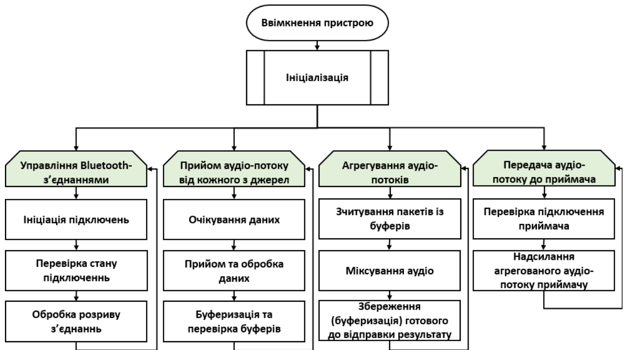
Рисунок 2.5 — Паралельний алгоритм агрегації аудіо-потоків
