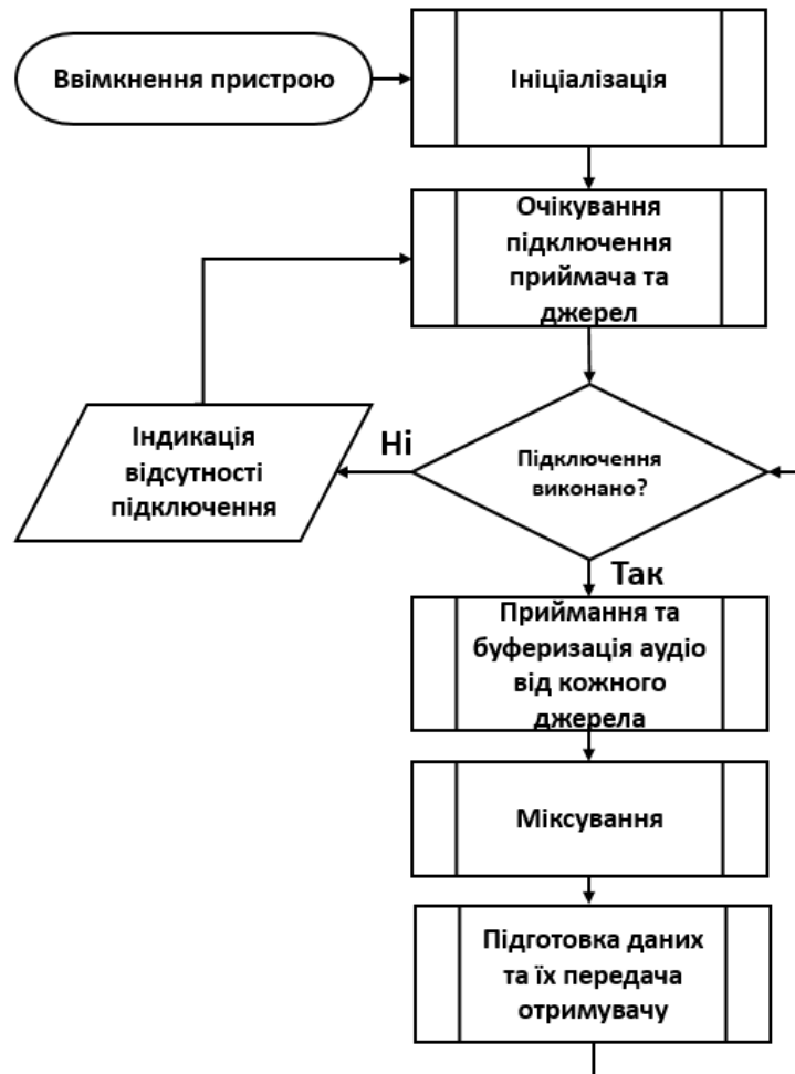
Рисунок 2.4 — Послідовний алгоритм агрегації аудіо-потоків
