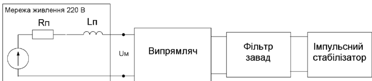
Рисунок 2.6 – Структурна схема імпульсного джерела живлення з фільтром завад, підключеного до мережі з паразитними параметрами
